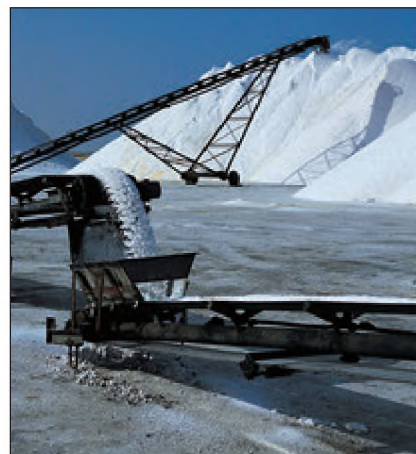
Рис. 7. Виробництво солі. Для того щоб отримати сіль, морську воду закачують у неглибокі резервуари. Під променями палючого сонця вода випаровується, і залишається сіль.
