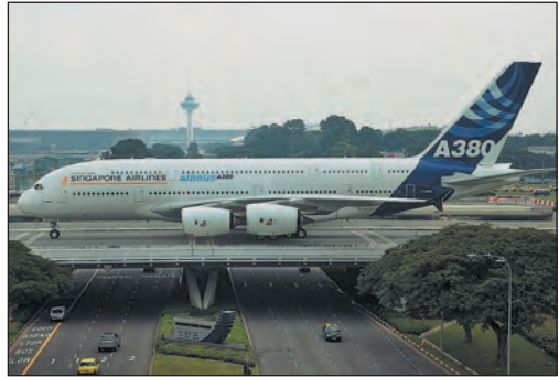
Мал. 2. Двопалубний реактивний пасажирський авіалайнер Аеробус А380 — найбільший серійний літак у світі.
