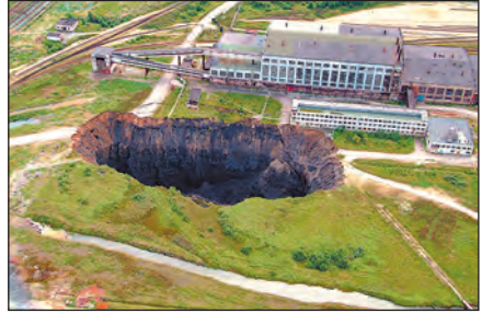
Мал. 2. Катастрофічне просідання ґрунту в місті Березники (Росія), що сталося у 2007 р. на соляному руднику. Розміри воронки — 450 на 330 м, глибина — до 90 м.
