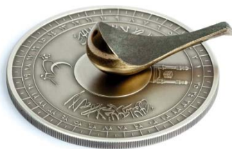
Мал. 43. Китайський компас у вигляді ковшика з магнетиту. Приблизно 2600 років до нашої ери
